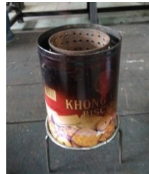
Gambar 5c. Silinder luar dan dalam tersusun konsentris
