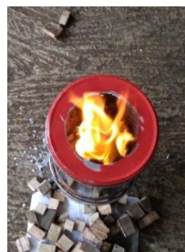
Gambar 6c. Api hasil pembakaran sekunder mulai terlihat
