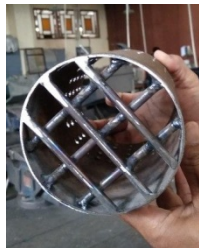
Gambar 5b. Anyaman besi beton sisi bawah silinder
