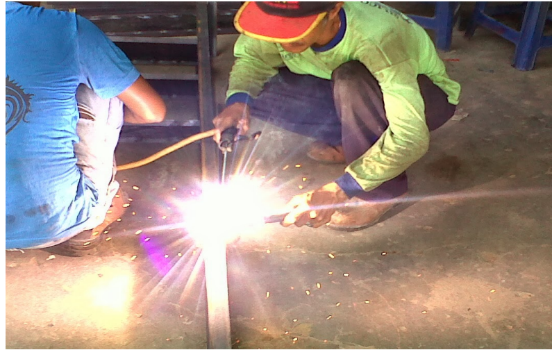
Gambar 1. Pekerja Melakukan Pengelasan tanpa APD
